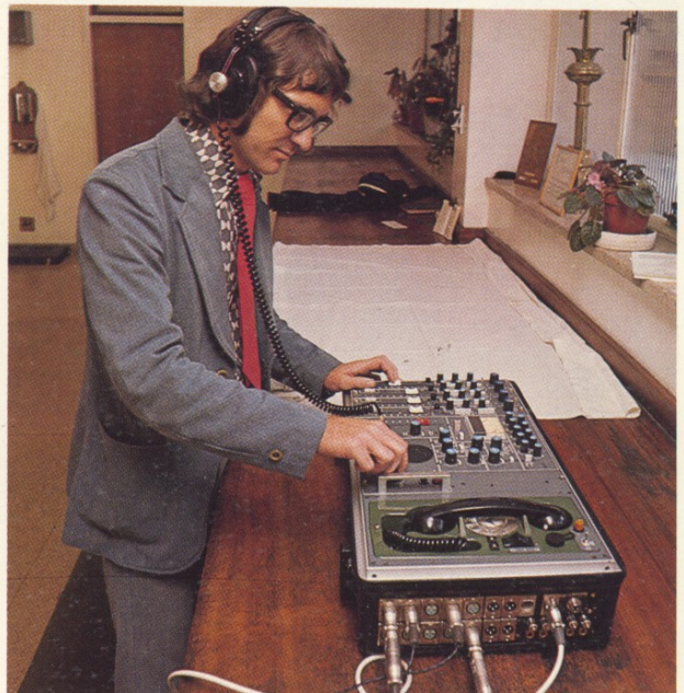
'n Ingenieur verbind die Cathedral of Christ the King in Johannesburg met Uitsaaisentrum deur 'n drakontrolebank in die sakristie.
